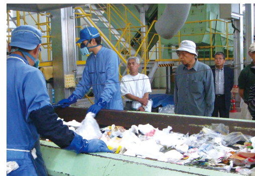
プラスチック製容器包装に混入している不適物を取り除くコンベヤ、手選別による仕分けが行われていました。
